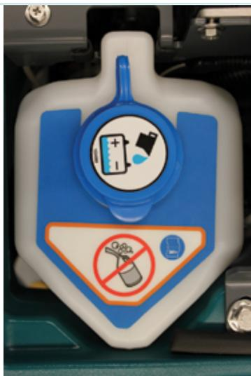
Um reservatório de água de bateria abastece automaticamente todas as baterias de forma ideal.
