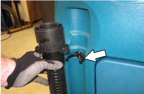
8. Se o filtro fica obstruído tanque de solução, retire a mangueira de drenagem para limpar o filtro e acesso.
