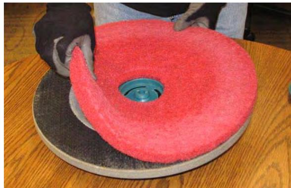
4. Vire ou substitua a almofada de lavagem. Centralize a almofada de lavagem no porta-almofadas e reinstale o disco central para prender a almofada no porta-almofadas.
