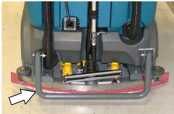
Para usar o protetor do rodo traseiro, puxe o parafuso, rebaixe a barra do protetor e reinsira o parafuso.
