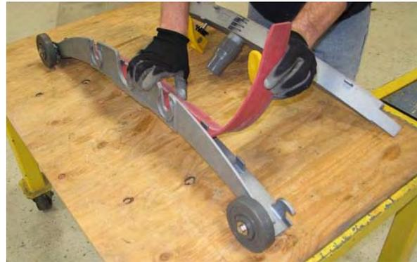
10. Instale a lâmina nova ou invertida do rodo no chassi externo. Verifique se o rodo está completamente inserido em cada uma das guias do chassi externo.
