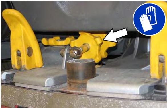
5. Gire o manípulo de ajuste de nivelamento do rodo no sentido anti-horário para diminuir a deflexão nas extremidades da lâmina do rodo.
