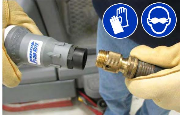
**OBSERVAÇÃO:** o suprimento de água ao sistema de água da bateria deve sempre ser de 7,57 l/min. (2 galões/min.) ou mais. Use o dispositivo de purga para confirmar a pressão do fornecimento de água. Consulte o Manual do Operador do Flow-Rite para obter informações adicionais.
