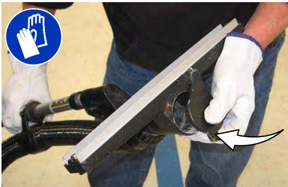
4. Gire o bico de aspiração para a posição de aspiração e estenda até o comprimento desejado.
