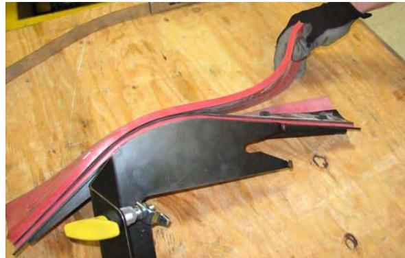
**OBSERVAÇÃO:** as lâminas do rodo possuem dois conjuntos de fendas para ajuste da deflexão da lâmina do rodo. Instale / reinstale os rodos de modo que a deflexão seja de aproximadamente 12 mm (0,50 pol.) para pisos lisos e de 15 mm (0,62 pol.) para pisos ásperos.
