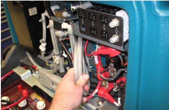
3. Pressione o botão do conector para desconectar a mangueira de saída do coletor do ec-H2O.
