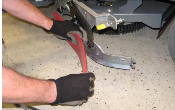
6. Instale a lâmina nova ou invertida do rodo no conjunto do rodo lateral.
