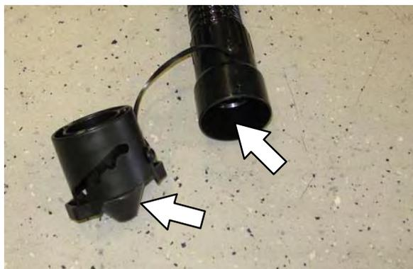
7. Gire a bacia do dreno fechada e insira a mangueira de drenagem de volta no clipe do tanque de recuperação.
