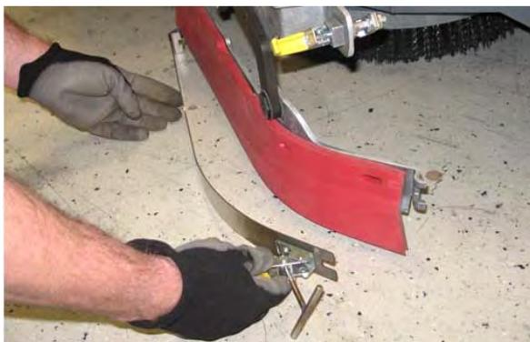
5. Remova a lâmina do rodo do conjunto do rodo lateral.
