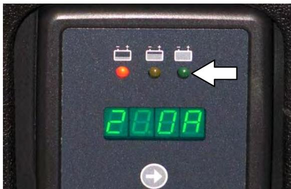
Se o carregador detectar um problema, ele exibirá um código de falha (Consulte **CÓDIGOS DE FALHA DO CARREGADOR DE BATERIA EMBUTIDO**).
