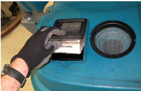
9. Remova a grade do aspirador do tanque de recuperação para limpá-la.
