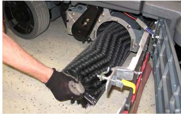
4. Posicione a escova com a extremidade de fileira dupla em direção à abertura do cabeçote de lavar. Direcione a nova escova sobre o cubo de acionamento.
