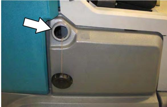
2. Encha parcialmente o tanque de solução com água (não mais de 60°C / 140°F). Despeje a quantidade apropriada de detergente no tanque de solução. Continue enchendo o tanque de solução com água até que o nível seja de aproximadamente 50 mm (2 pol.) abaixo da tampa.
