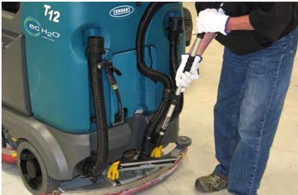
3. Insira a tampa do tubo de aspiração na abertura do tubo de aspiração.
