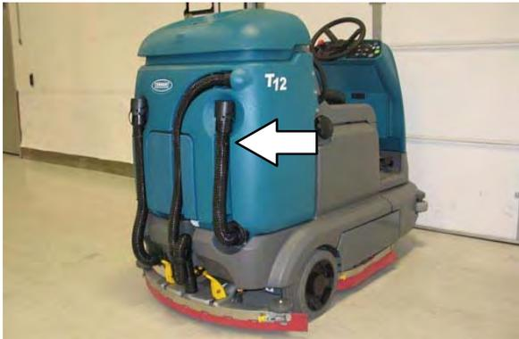
3. Segure o tubo de drenagem próximo de uma drenagem de piso, gire o bico de drenagem e coloque o tubo próximo da drenagem de piso.
