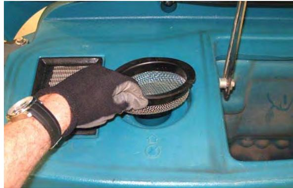
10. Remova a bandeja de detritos do tanque de recuperação e enxague todos os detritos da bandeja.
