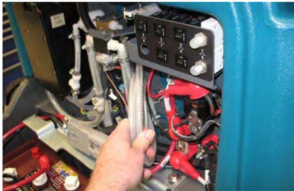
4. Desconecte a mangueira de saída do cabeçote de lavar da mangueira do coletor do *ec-H2O*.
