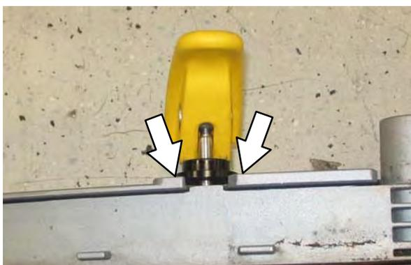
13. Instale a lâmina nova ou invertida do rodo no chassi interno. Verifique se o rodo está firmemente fixado em cada uma das guias do chassi interno.
