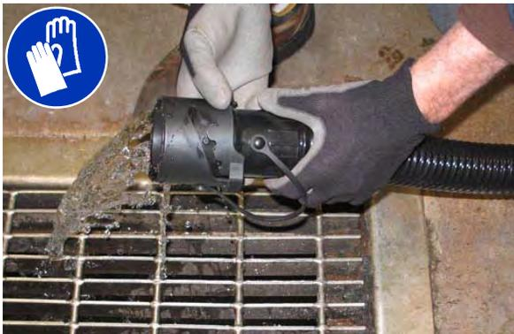
4. Se necessário, gire o bico de drenagem para outra posição para ajustar o fluxo.
