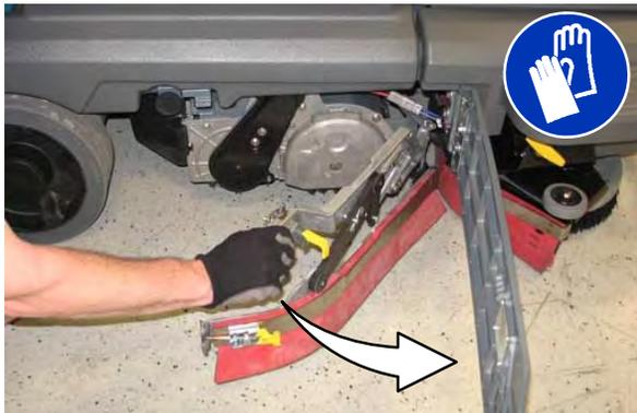
2. Remova a placa de apoio do cabeçote de lavar.
