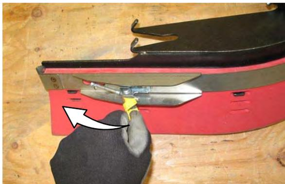
3. Remova a faixa de retenção, as lâminas do rodo e o espaçador do chassi do rodo.
