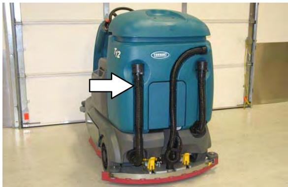
3. Segure o tubo de drenagem próximo de uma drenagem de piso, gire o bico de drenagem e coloque o tubo próximo da drenagem de piso.
