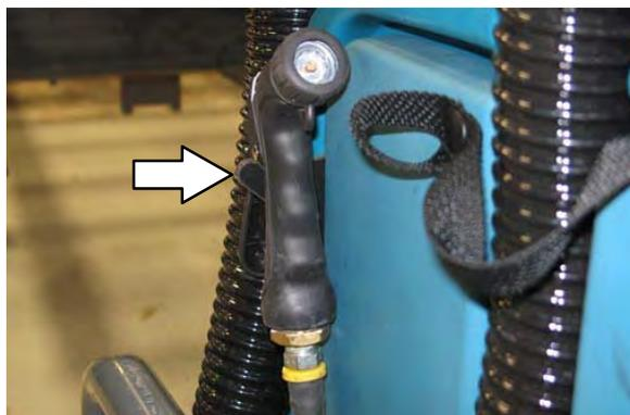
6. Pressione a parte inferior do *interruptor do bico de pulverização* para desligar o fornecimento de água. A luz no interruptor apagará quando o bico pulverizador estiver desligado.
